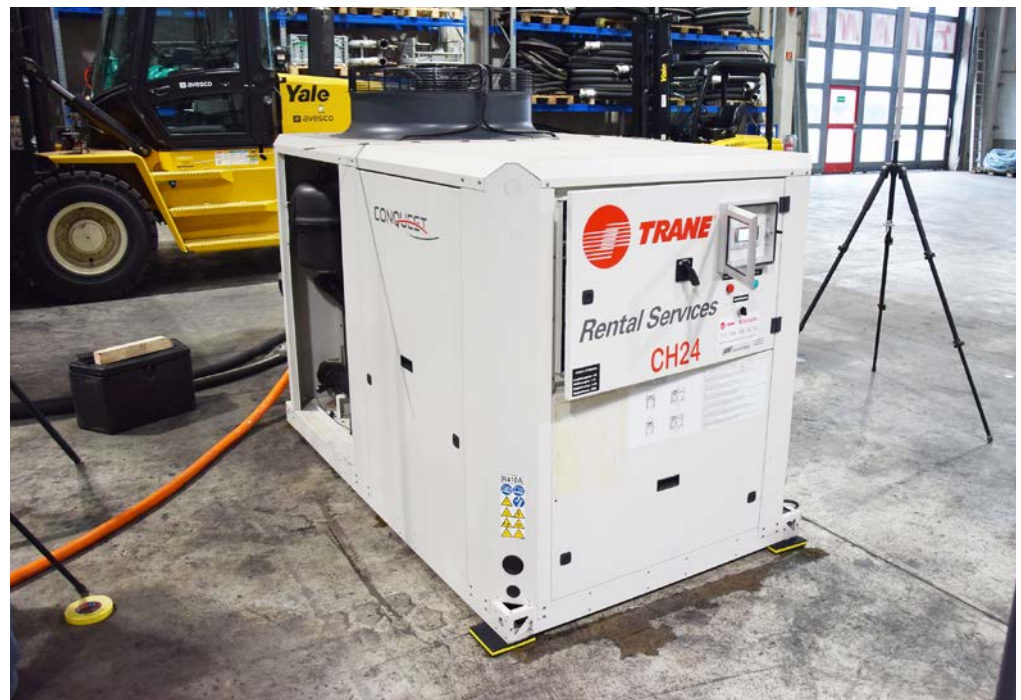
Fig. 1 - Prove di isolamento dalle vibrazioni originate dal funzionamento di una pompa di calore raffreddata ad aria con compressore Scroll
